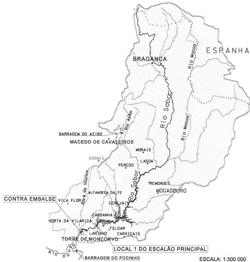
Figura 1 – Planta de localização geral do aproveitamento.
